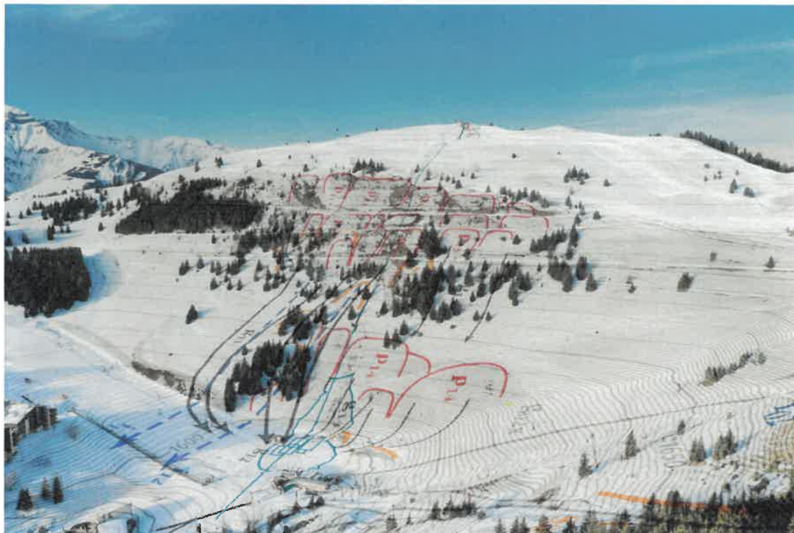
Figure 2.7 – Vue oblique partielle du schéma de fonctionnement des avalanches sur le secteur des Sûres. Les tracés bleu clair localisent le projet.
