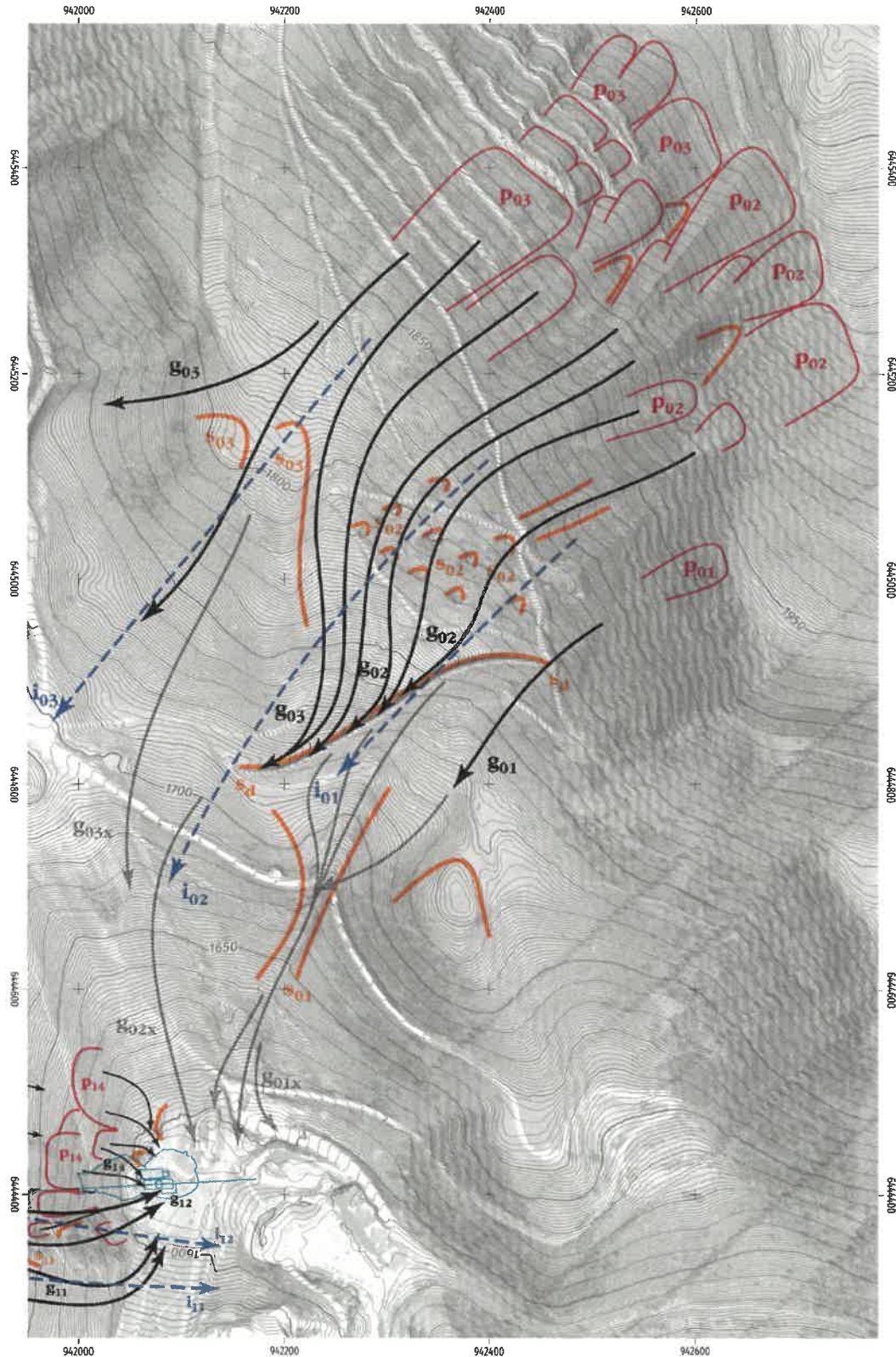
Figure 2.8 – Schéma de fonctionnement des avalanches sur le secteur du Signal de l’Homme. Les tracés bleu clair localisent le projet. Échelle 1:6 000. Fond topographique Lidar Sintegra, orthophotoplan Géoportail © IGN 2022. Système de coordonnées Lambert 93.
