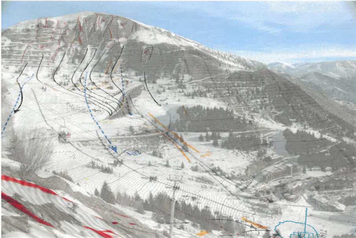
Figure 2.9 – Vue oblique partielle du schéma de fonctionnement des avalanches sur le secteur du Signal de l'Homme.
